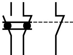
Пример механически связанных замыкающего и размыкающего контактов и несвязанного размыкающего контакта
