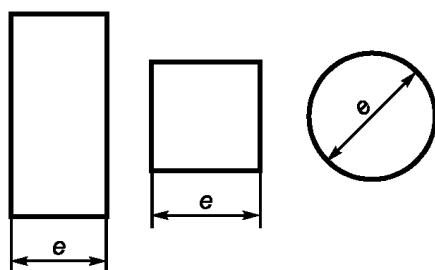
Рисунок D.1 - Форма и размеры отверстия
