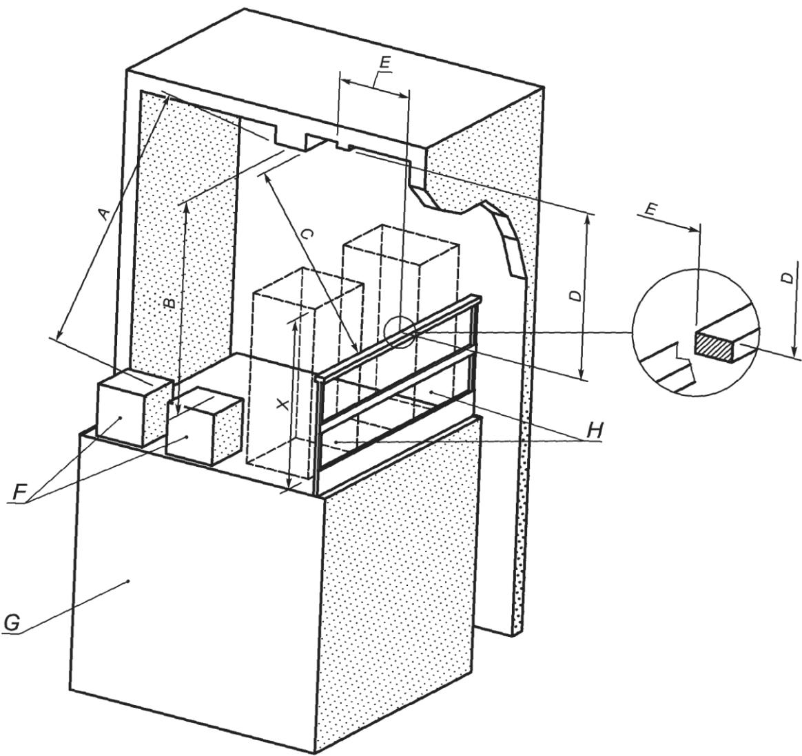
А - расстояние  $\geq 0,50$  м [5.2.5.7.2 а]; В - расстояние  $\geq 0,50$  м [5.2.5.7.2 а]; С - расстояние  $\geq 0,50$  м [5.2.5.7.2 с) 2]; Д - расстояние  $\leq 0,30$  м [5.2.5.7.2 с) 1]; Е - расстояние  $\leq 0,40$  м [5.2.5.7.2 с) 1]; F - выступающие части установленного на крыше кабины оборудования; G - кабина; H - пространство (пространства) безопасности для персонала; X - высота пространств безопасности (см. таблицу 3)
