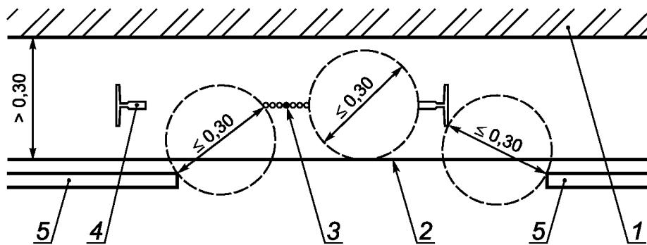
1 - лифт и шахта; 2 - край крыши кабины лифта; 3 - канаты, ремни; 4 - направляющие; 5 - перильное ограждение
