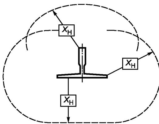
Рисунок 6 - Горизонтальное расстояние  $X_H$  вокруг направляющей
